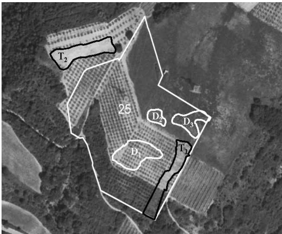
Fig. 6 Foto aerea con rilevamento GIS delle particelle catastali (n. 25), delle aree danneggiate ( D_1, D_2, \dots, D_n ) e delle tare ( T_1, T_2, \dots, T_n )
