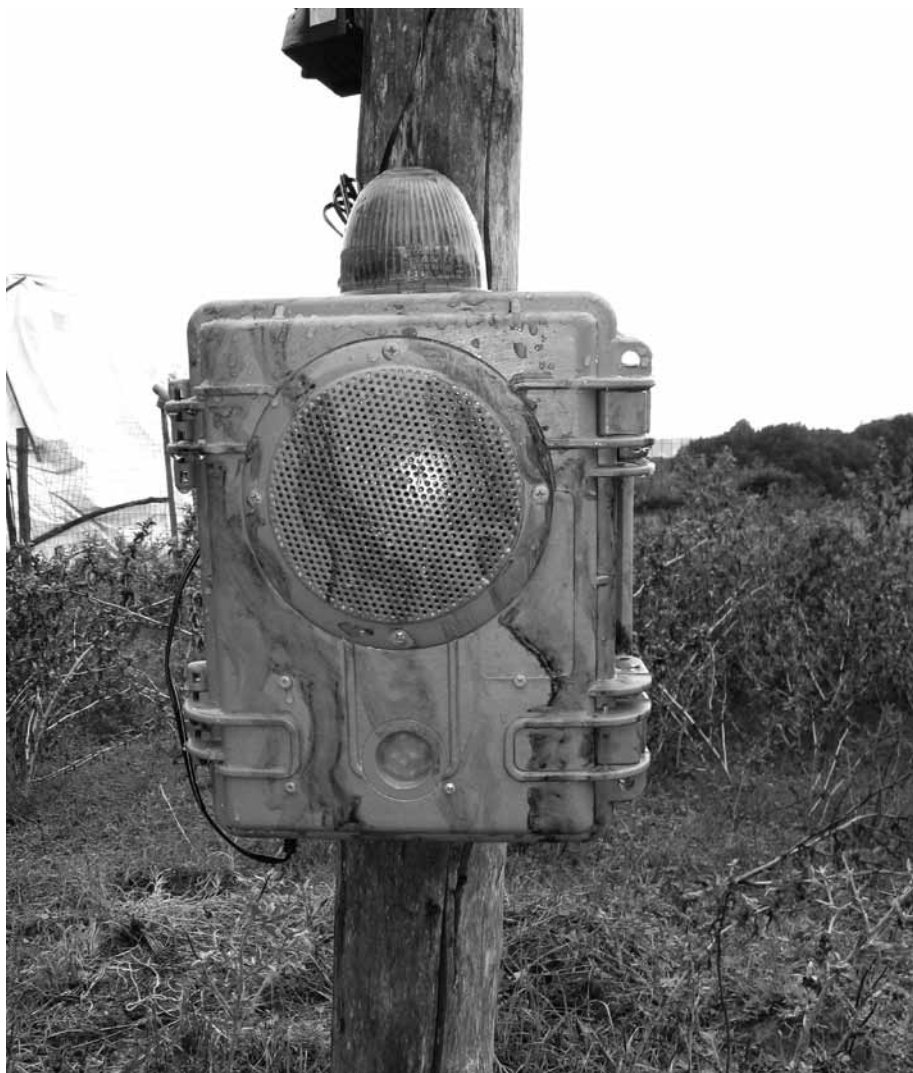
Fig. 11 Dissuasore ottico-acustico
