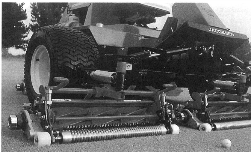
Fig. 6 Nell'apparato elicoidale sono aumentate le lame che, per il taglio dei tee e dei green dei campi da golf, raggiungono il numero di 11-12
