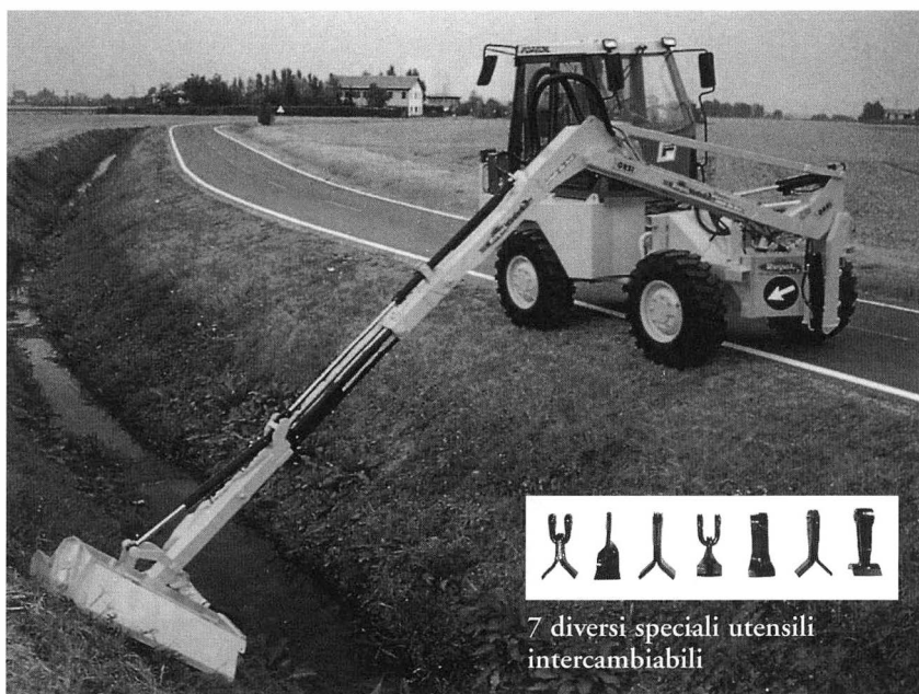
Fig. 9 Braccio telescopico con apparato a utensili intercambiabili
