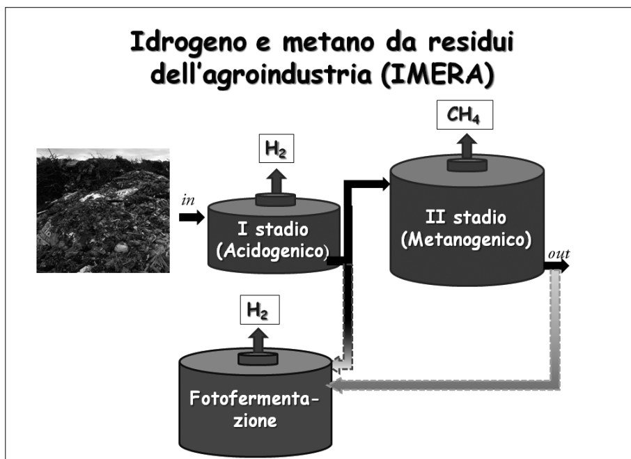
Fig. 6 Schema del progetto "Idrogeno e metano da residui dell'agroindustria" (IMERA), coordinato dall'Università di Firenze. Per i dettagli vedi il testo
