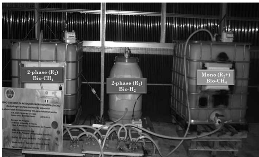
Foto 2 Impianto pilota a due fasi (reattori R1+R2, a biomassa microbica dispersa), in scala semi-industriale, alimentato in semi-continuo per la produzione di Bio-H 2 e Bio-CH 4
