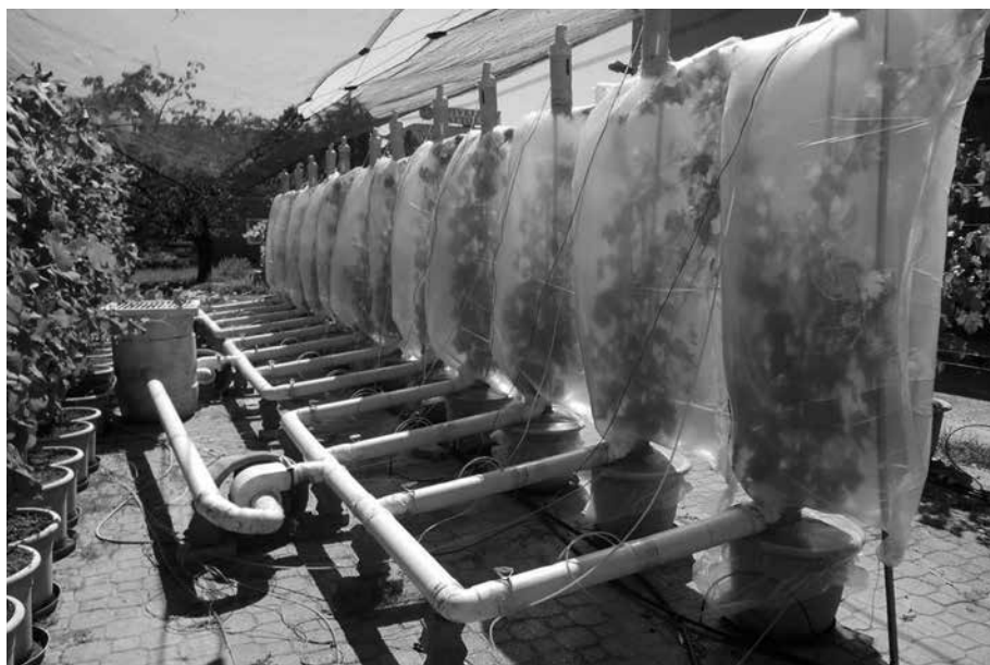
Fig. 7 Il sistema di scambio gassoso sviluppato presso il DI.PRO.VE.S dell'Università Cattolica che consente di condurre studi totalmente automatizzati di stress idrico in cui la quantità di acqua erogata alle vite può essere una qualsiasi frazione della quota effettivamente traspirata misura, in continuo, dal sistema stesso. Foto dell'Autore
