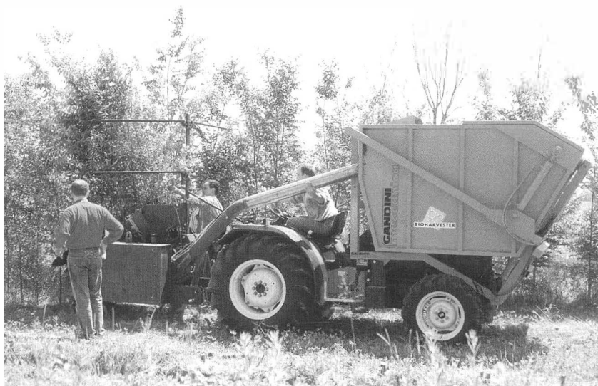
Fig. 9 Prototipo di costruzione italiana per la raccolta e sminuzzatura meccanizzata delle Short Rotation Forestry
