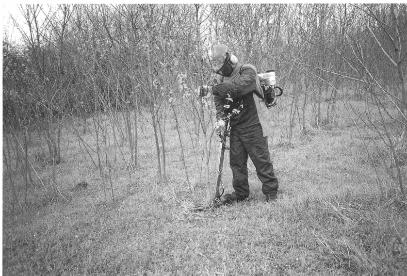
Fig. 11 Prototipo di cesoie idrauliche spalleggiate, di costruzione italiana, per l'abbattimento semiccanico delle Short Rotation Forestry (da Baldini et al., 2002)
