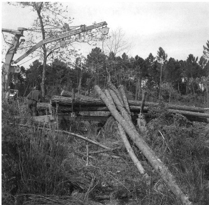
Fig. 18 Rimorchio forestale dotato di gru meccanica e verricello, agganciato ad un trattore agricolo
