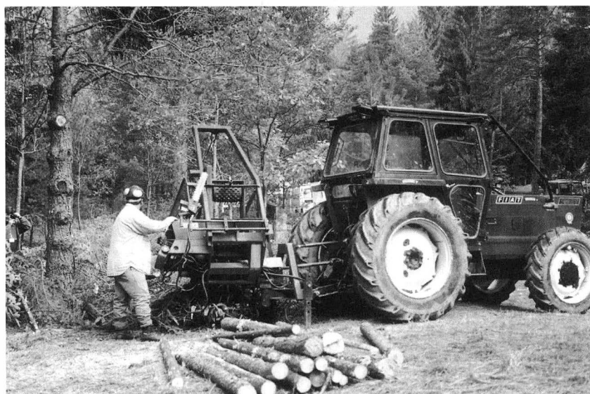
Fig. 17 Macchina allestitrice azionata tramite la presa di potenza del trattore, dotata di verricello per il concentramento delle piante
