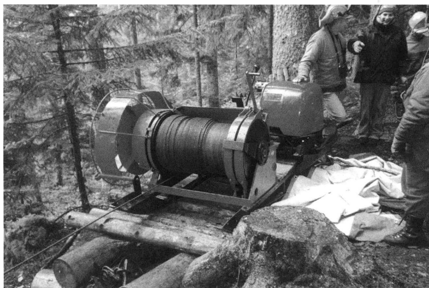
Fig. 21 Corso di formazione per teleferisti, stazione motrice costituita da argano montato su slitta
