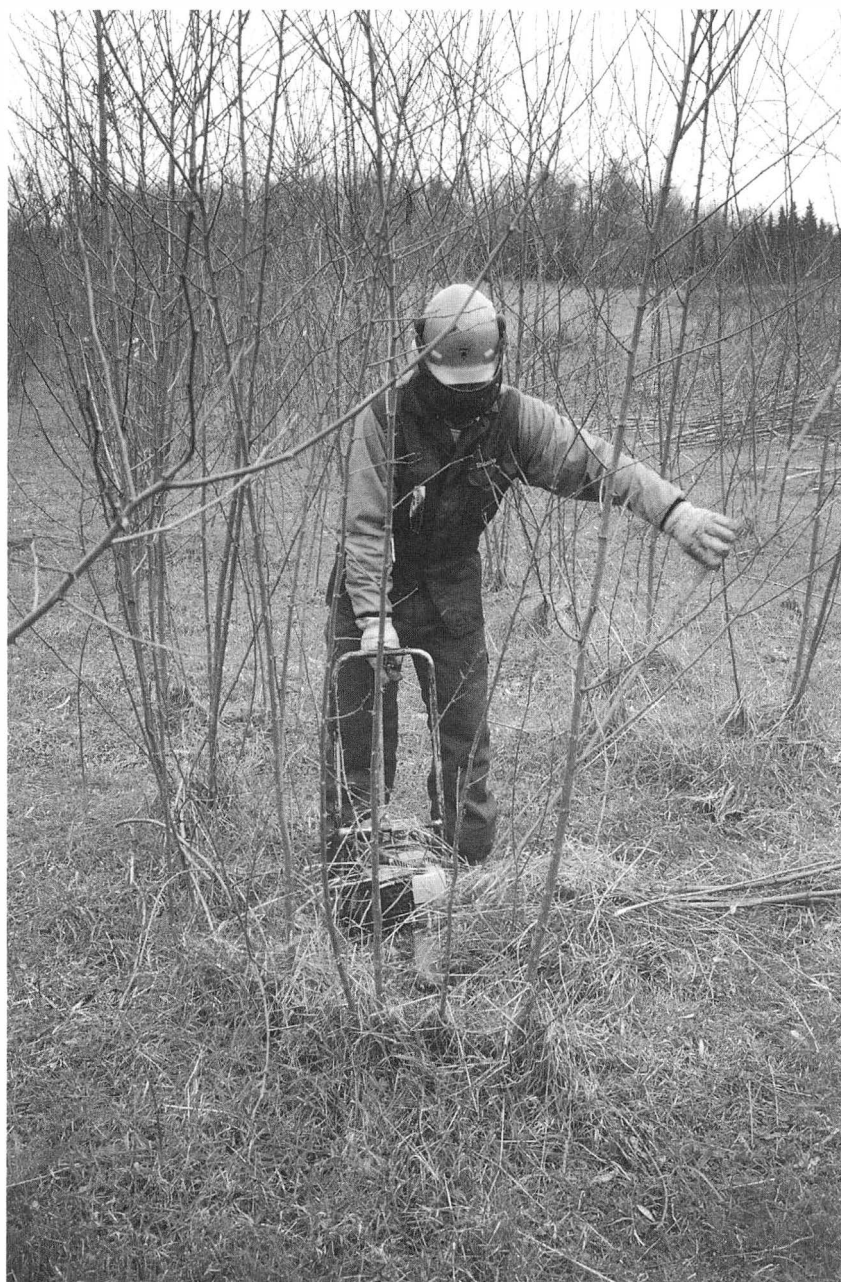
Fig. 12 Motosega munita di telaio per l'abbattimento semimeccanico delle Short Rotation Forestry (da Baldini et al., 2002)
