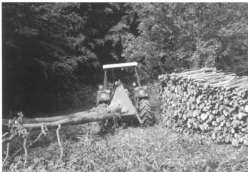
Fig. 19 Trattore agricolo con verricello forestale ad un tamburo dotato di piedi telescopici stabilizzanti
