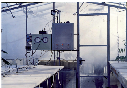
Fig. 1 Prototipo di serra di nebulizzazione costruita dall'Istituto di Coltivazioni Arboree di Pisa nel 1960, dove sono state condotte le prime ricerche sulla propagazione per talea dell'olivo e del pesco
