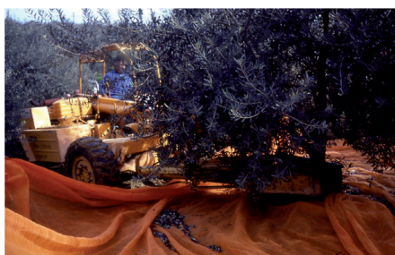
Fig. 14 Macchina scuotitrice per la raccolta delle olive che vengono intercettate da reti di plastica stese sotto la chioma degli alberi
