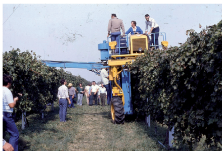
Fig. 17 Raccolta meccanica dell'uva mediante scuotitura orizzontale in forme di allevamento a controspalliera
