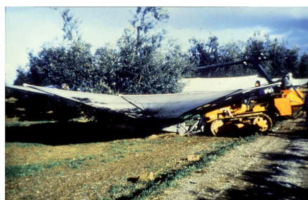
Fig. 15 Macchina per la raccolta delle olive provvista di braccio scuotitore del tronco e intercettatore a ombrello
