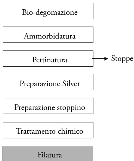
Fig. 6 Sequenza delle fasi di processo, necessarie alla preparazione della fibra ottenuta dal processo di bio-degommazione per la filatura
