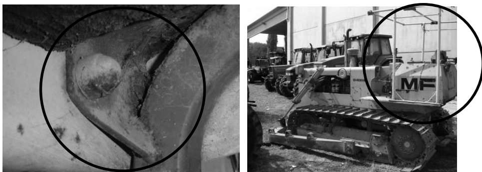
A sinistra: corrosione di un rinforzo e della sua saldatura; a destra: robustezza assolutamente insufficiente del "telaio" (in realtà è un semplice scheletro di un riparo meteorologico) collocato intorno al posto di guida
