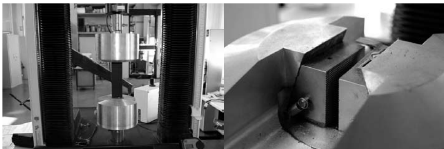
Fig. 5 Attrezzatura di prova per la trazione e particolare del dispositivo di serraggio
