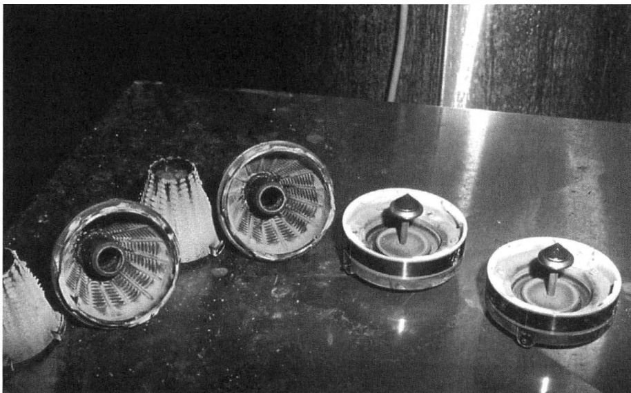
Fig. 15 L'accumulo di sporcizia all'interno della valvola di regolazione del vuoto ne pregiudica il corretto funzionamento
