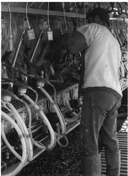
Fig. 7 Il vuoto risulta molto più stabile se il diametro interno del tubo corto del latte misura 10 mm in luogo di 8 mm
