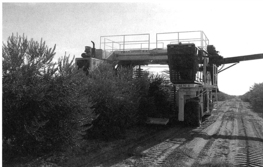
Figura 3. Grande macchina scavallatrice ("Colossus", con struttura rigida di 4x4 m) che consente la raccolta da impianti a vaso libero o ad asse centrale.
