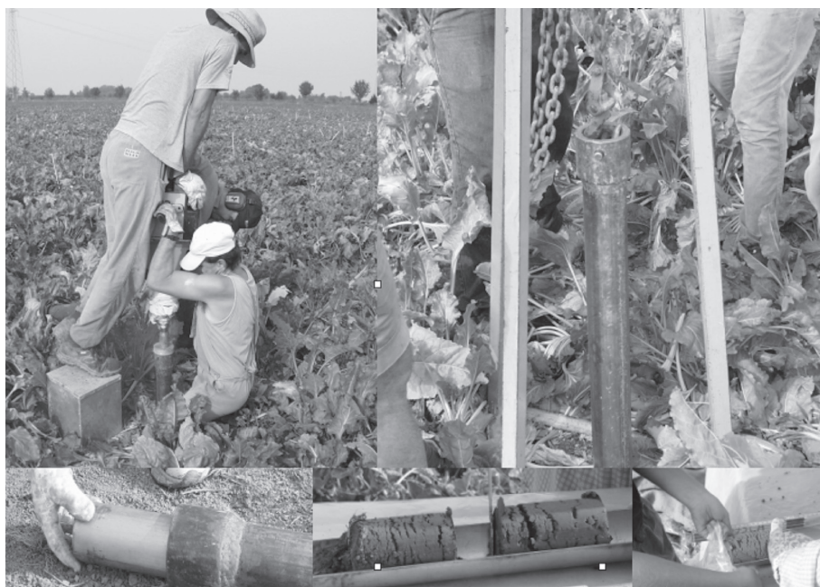
Fig. 3 Metodo del carotaggio: fasi di raccolta campioni (Foto: Vameralli)
