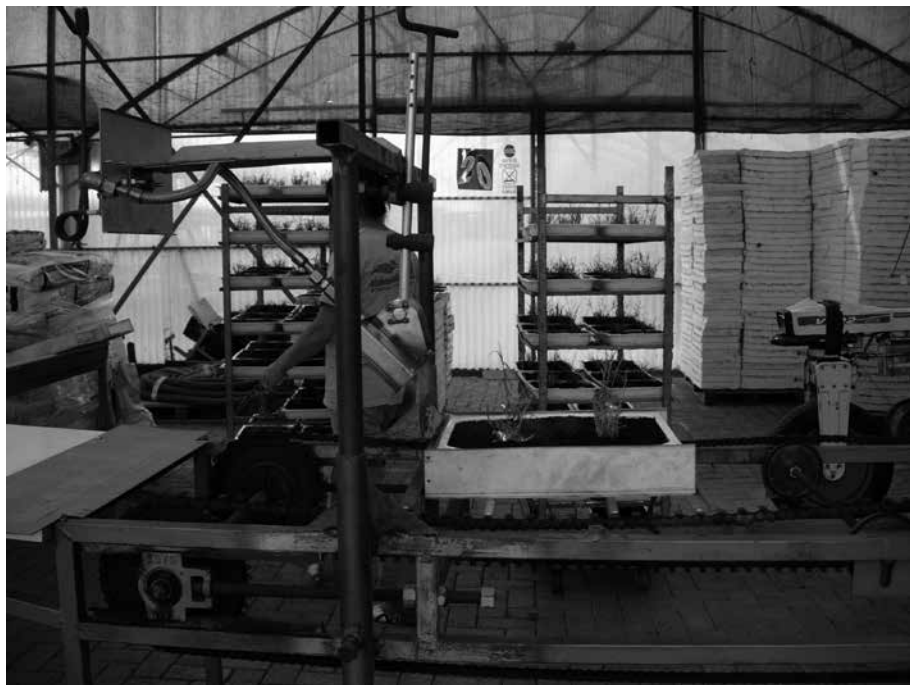
Fig. 10 Banco prova impiegato per effettuare test di tolleranza di specie macroterme da tappeto erboso al pirodiserbo
