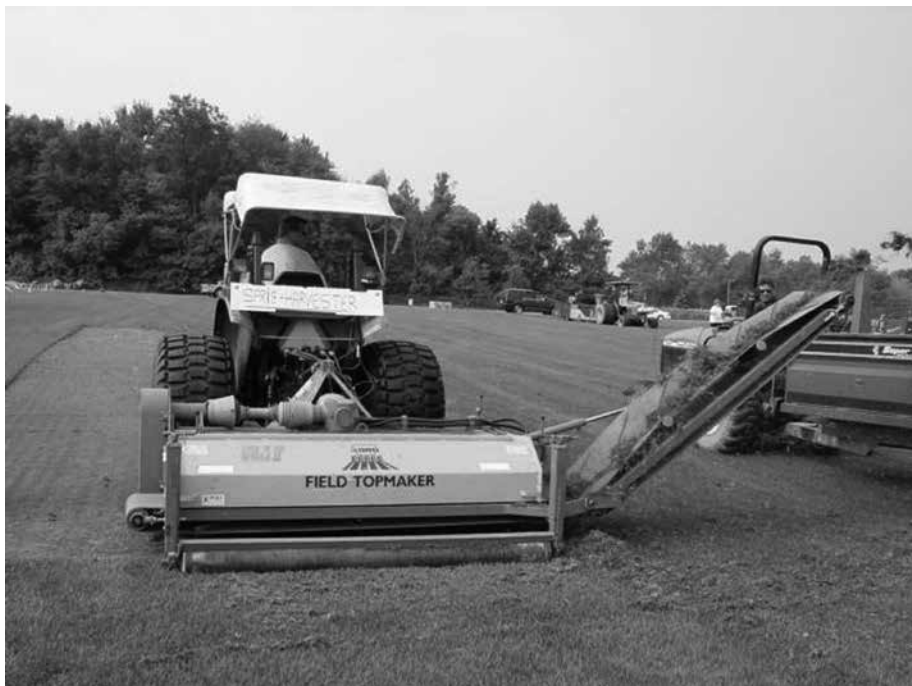
Fig. 1 Prelievo meccanico stoloni da vivaio
