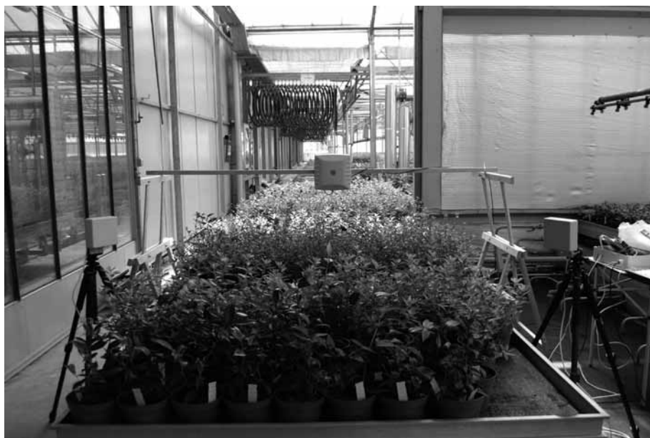
Fig. 4 Identificazione di 80 piante movimentate su un bancale mediante antenne UHF
