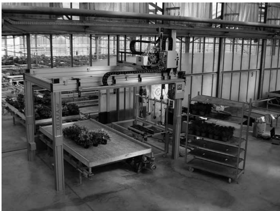
Fig. 2 Il secondo prototipo realizzato dal D.E.I.A.F.A., cartesiano con struttura a portale
