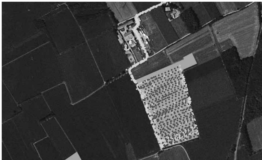
Fig. 11 Mapa di distribuzione realizzata con il sistema di controllo innovativo. Punti scuri = valvola aperta; punti chiari = valvola chiusa
