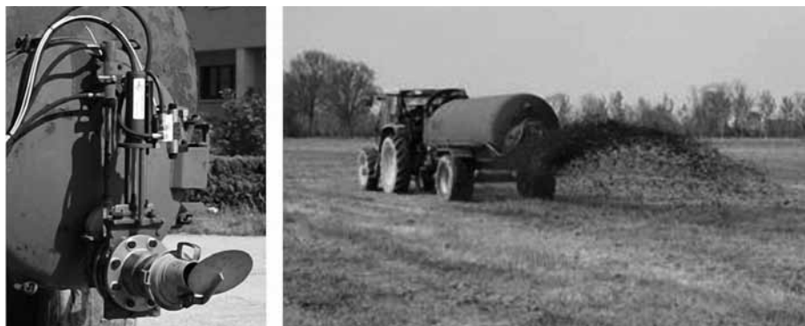
Fig. 9 Esecuzione delle prove di campo effettuate impiegando il sistema realizzato nel progetto Metamorfosi . Notare la vetustà del carro botte impiegato a dimostrazione della possibilità di impiego del sistema in qualsiasi ambito. In base a quanto sopra detto queste operatrici non dovrebbero essere più impiegate in aree vulnerabili, ma già un loro impiego corretto potrebbe portare benefici a livello sia aziendale sia sociale per il minore impatto ambientale conseguente
