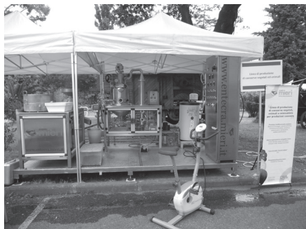
Fig. 4 Linea per la produzione di conserve vegetali e animali e mini-caldia per produzioni casearie (confetture, passate, conserve in genere, salse, paté)
