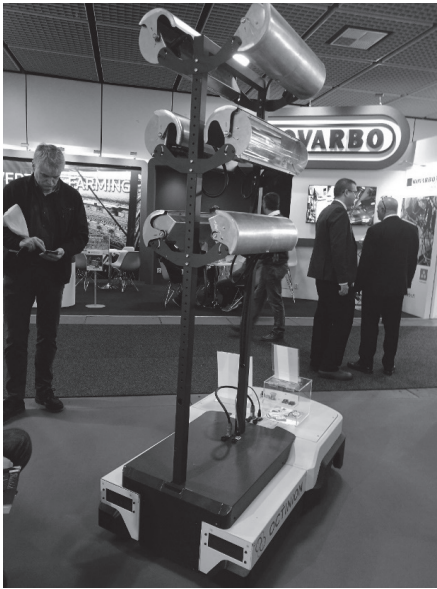
Fig. 2 Robot per trattamenti UV per controllo oidio e botrite in colture di fragole fuori suolo in serra. Particolare delle lampade UV
