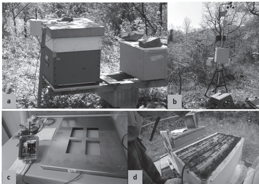
Fig. 1 Apiario con bilancia e sensori installati (a), stazione meteorologica in prossimità dell'apiario (b), bilancia pesa arnia (c), sensori umidità e temperatura posizionati internamente all'arnia (d)
