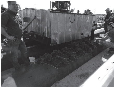
Fig. 3 Sistema trainato e robot per trattamenti UV per controllo oidio e botrite in colture di fragole in pieno campo. Particolare delle lampade UV
