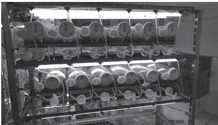
Fig. 4 Batteria di 12 bioreattori SETIS™ per la coltura in TIS di nocciolo ( Corylus avellana ) presso il laboratorio di micropropagazione della Battistini vivai di Cesena (per gentile concessione di Massimiliano Meneghini)
