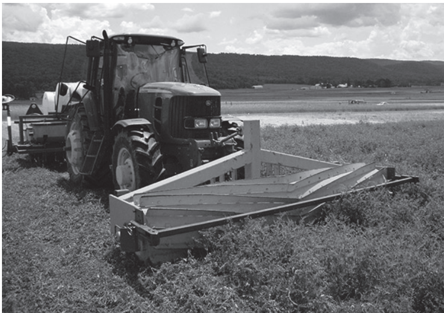
Fig. 2 Devitalizzazione della coltura di copertura con rullo scanalato tipo “Roller crimper”
