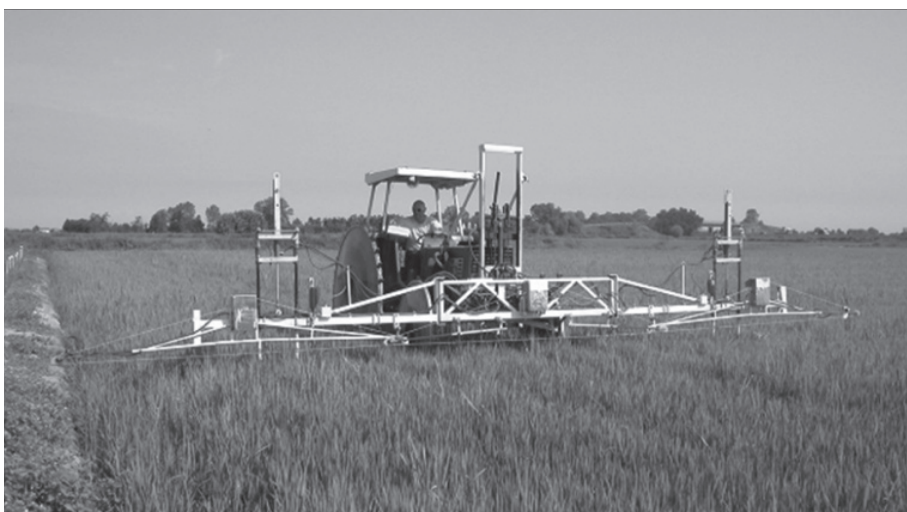
Fig. 4 Diserbatrice a barra umettante per la lotta contro il riso crodo, in presenza della coltura
