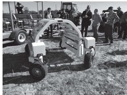
Fig. 3 Sistema trainato e robot per trattamenti UV per controllo oidio e botrite in colture di fragole in pieno campo. Particolare delle lampade UV
