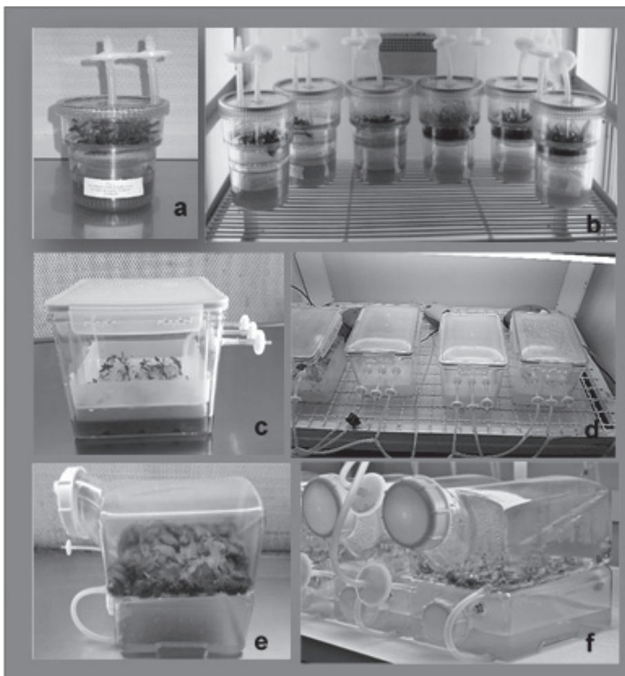
Fig. 1 Diversi tipi di bioreattori per coltura ad immersione temporanea: a, b) germogli binodali di olivo, cv Canino, in coltura in bioreattore RITA®, con tempi di immersione di 16 min ogni 16 h (Lambardi et al., 2006); c, d) germogli binodali di olivo, cv Canino, in coltura in bioreattore Plantform™, con tempi di immersione di 8 min ogni 16 h e ventilazione di 15 min ogni 4 h (Benelli e De Carlo, 2108); e, f) germogli di actinidia, cv Hayward, in coltura in bioreattore SETIS™, con tempi di immersione di 8 min ogni 16 h
