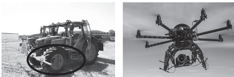
Fig. 2 Sensori montati sul frontale della trattoria (proximal sensing) oppure su droni (remote sensing)
