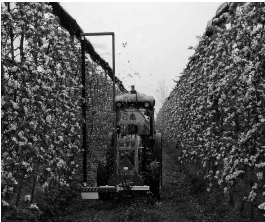
Fig. 11 Diradamento dei fiori in filari a siepe stretta e alta di meleli con barra flagellatrice Darwin
