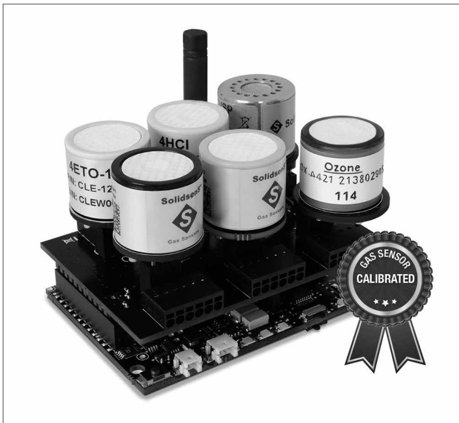
Fig. 9 La scheda per il monitoraggio dei Gas è già cablata e deve solo essere inserita negli appositi pin dello Wasmote, inoltre i sensori sono calibrati e forniti di certificazione, parametri fondamentali che distinguono un sensore per misure hobbistiche da uno per quelle scientifiche
