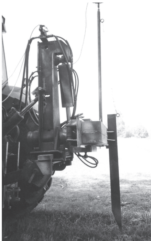
Fig. 11 Telaio di supporto a slitta mobile di una trapiantatrice equipaggiato solamente di dente assolcatore per consentire l'esecuzione delle prove sperimentali. Notare l'antenna montata solidalmente al disopra del dente
