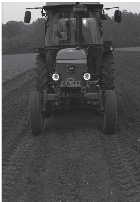
Fig. 6 Sovrapposizione di due passate di lavoro successive sulla medesima traccia con trattore guidato dal secondo prototipo descritto nel testo
