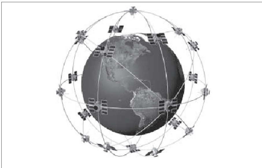
Fig. A.3 I satelliti del segmento spaziale GPS girano su orbite definite delle quali si conosce il tracciato (effemeride). I ricevitori sono in grado di ricevere il numero di satelliti che stanno nella loro parte visibile del cielo (almanacco) e di ricostruire le effemeridi
