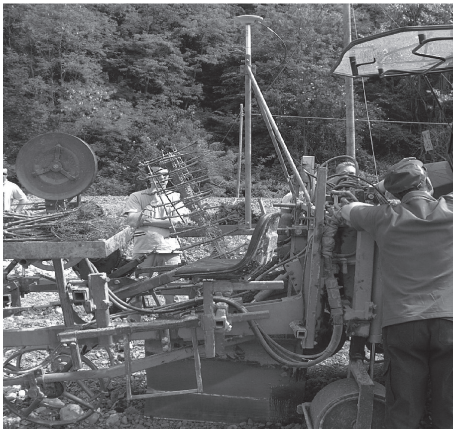
Fig. 10 Trapiantatrice a guida GPS portata da trattore. La macchina vera e propria è montata su un telaio a slitta (parte verde) in grado, a comando, di traslare trasversalmente rispetto alla direzione di avanzamento. Notare l'antenna montata solidale sulla trapiantatrice
