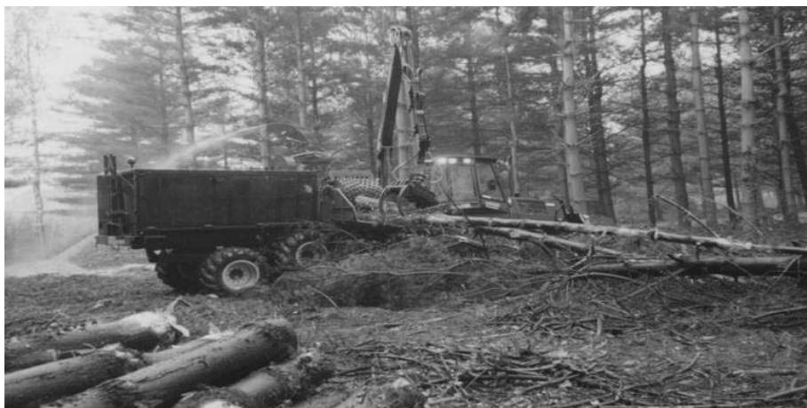
Foto 7 Operazione di sminuzzatura in bosco di piante intere di rami
