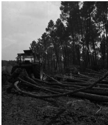
Foto 15 Esbosco con trattore e verricello forestale di fusti interi sramati di Pino
