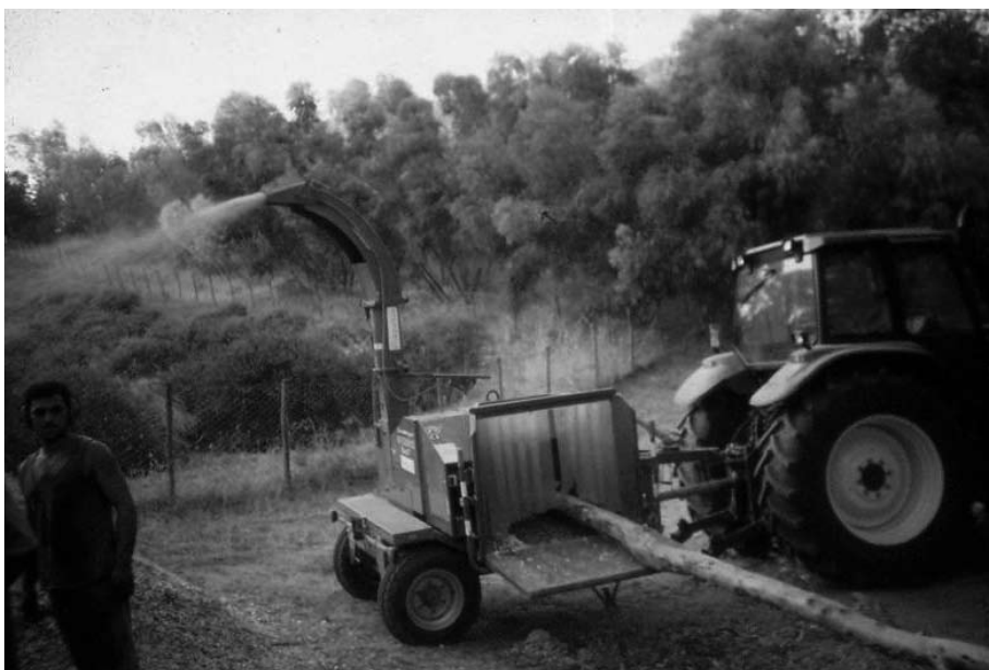
Foto 20 Sminuzzatura della pianta intera
