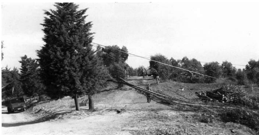
Foto 19 Esbosco delle piante intere con minigru a cavo
