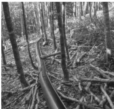
Foto 16 Concentramento della legna da ardere con canalette in PVC
