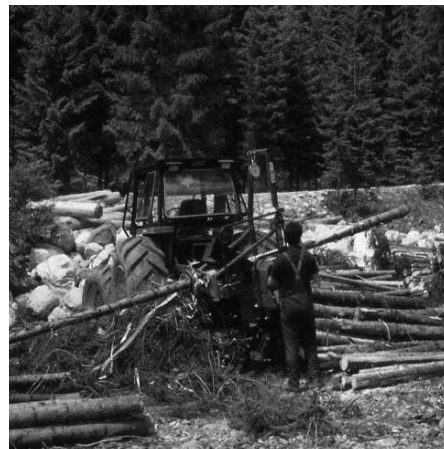
Foto 10 Sramatura e sezionatura con macchina combinata applicata a trattore agricolo
