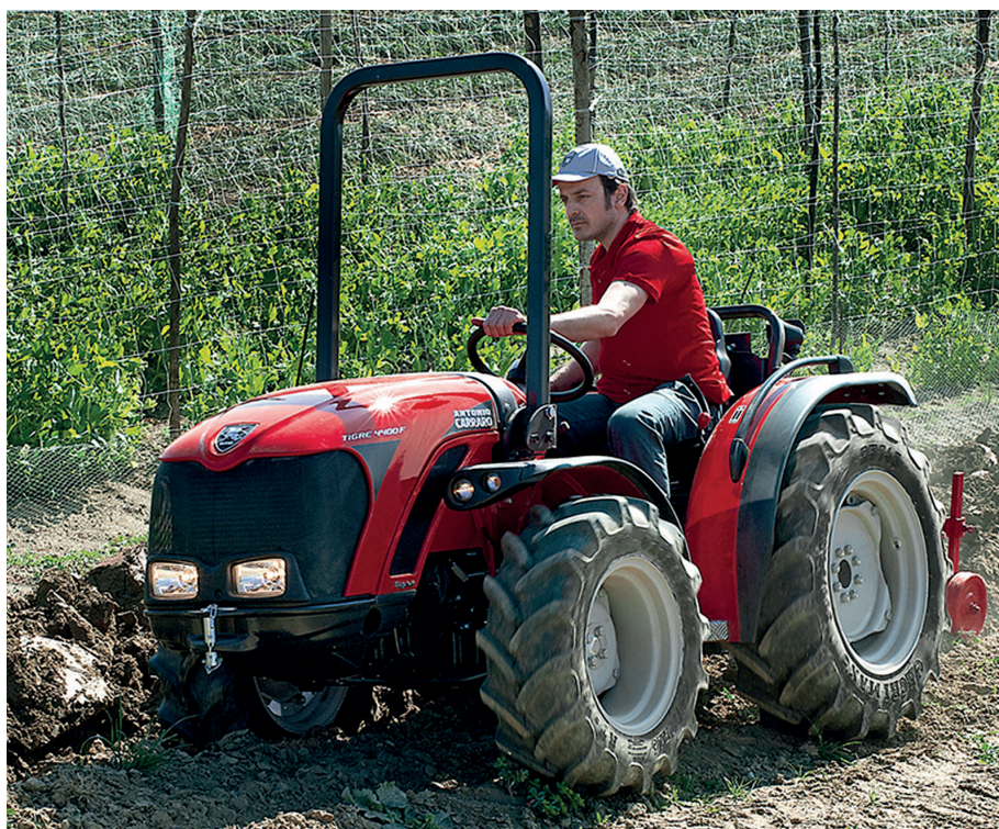
Fig. 2 L'arco a due montanti anteriore mantenuto in posizione verticale di protezione (unitamente alla cintura di sicurezza regolarmente allacciata) è fondamentale per la sicurezza del trattorista in caso di ribaltamento
