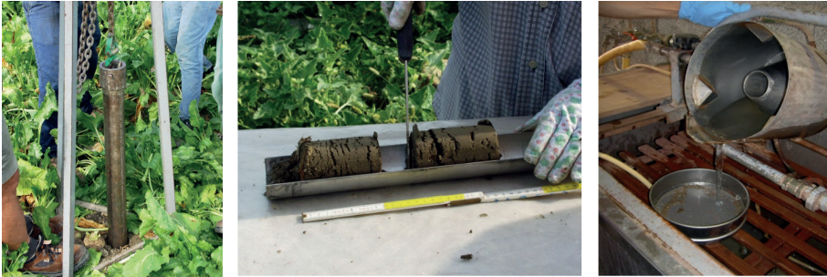
Sistema di prelevamento di carote di terreno, suddivisione del profilo e lavaggio per la separazione delle radici
