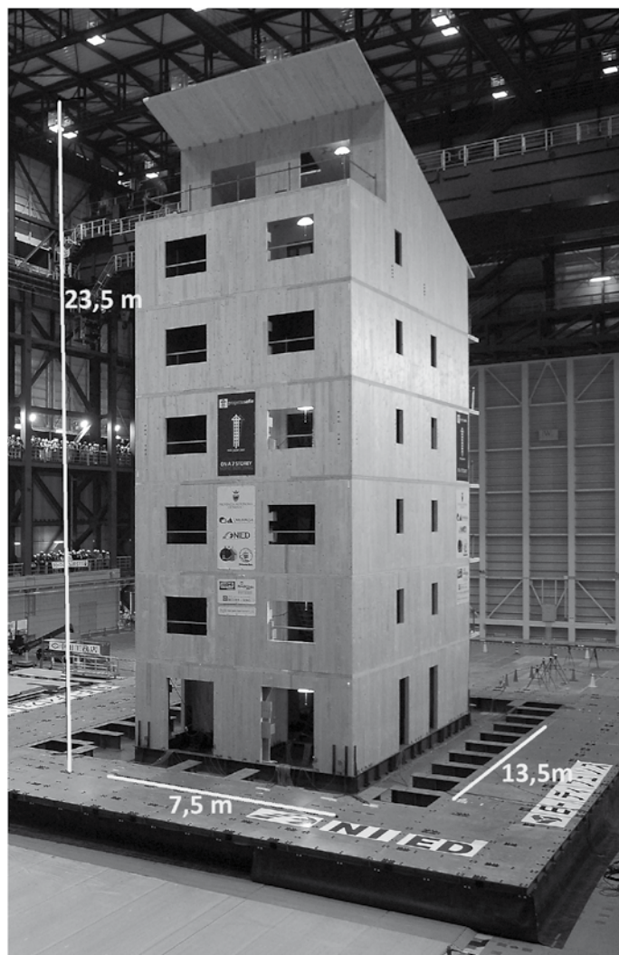
Fig. 3 L'edificio SOFIE di 7 piani dopo tutti i test sismici svolti presso il laboratorio NIED di Kobe, in Giappone
