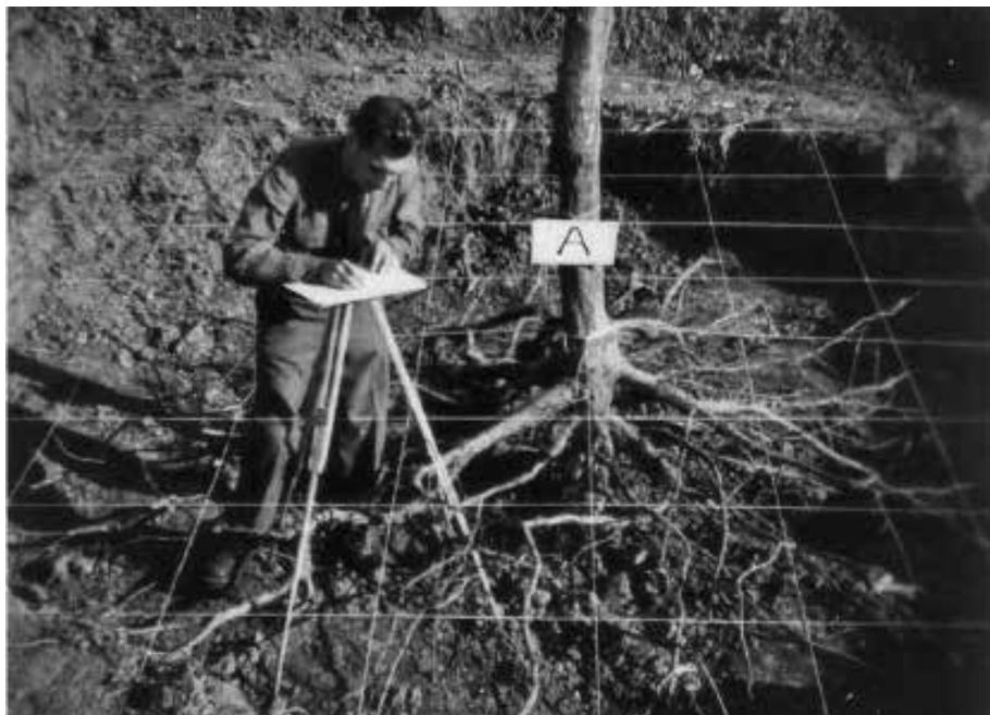
Foto 3 Nelle indagini sui sistemi radicali delle piante arboree le singole radici, isolate dal terreno circostante, vengono pazientemente quotate e disegnate
