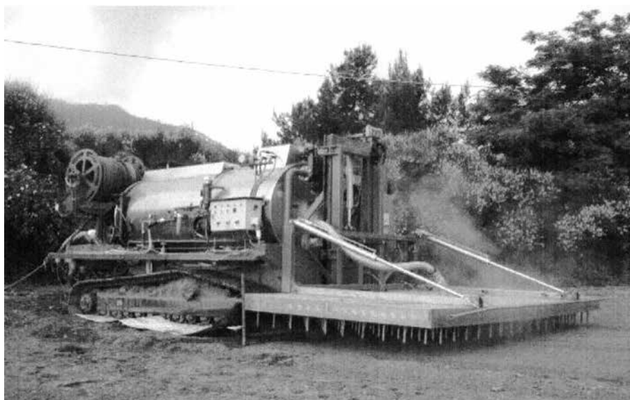
Fig. 9 Trattamento per la disinfestazione del terreno con vapore surriscaldato a iniezione in contro flusso
