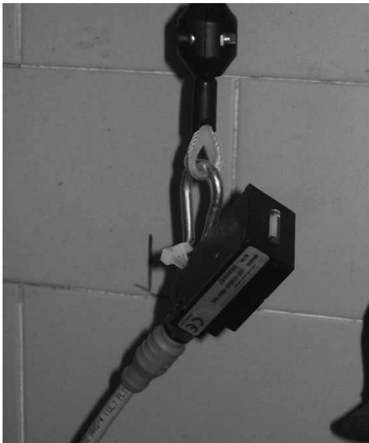
Fig. 16 Apparecchio per lettura/scrittura dei tag alimentari da inserire nelle confezioni sottovuoto
