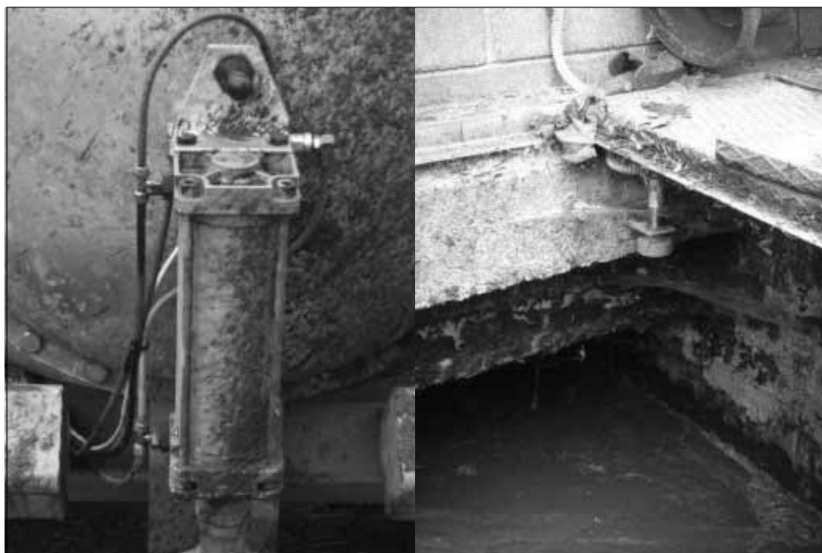
Fig. 22 A sinistra: sensore di pressione installato sulla valvola di scarico dello spandiliquame; a destra: sensore a ultrasuoni applicato sopra la fossa dei liquami
