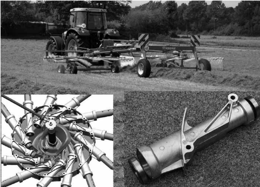
Fig. 5 Alloggiamenti di cuscinetti dei bracci di un ranghinatore a girello realizzati in lega leggera di alluminio
