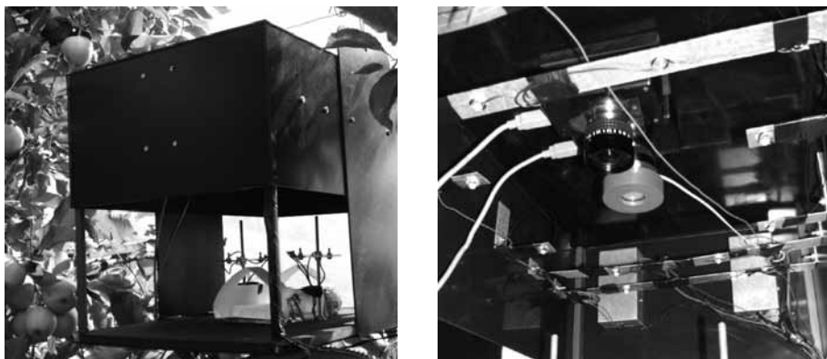
Fig. 7 Prototipo dell'unità di monitoraggio automatica installata in meeto per prove di attrazione su Cydia pomonella e, a destra, dettaglio del sistema di acquisizione e di illuminazione a infrarossi
