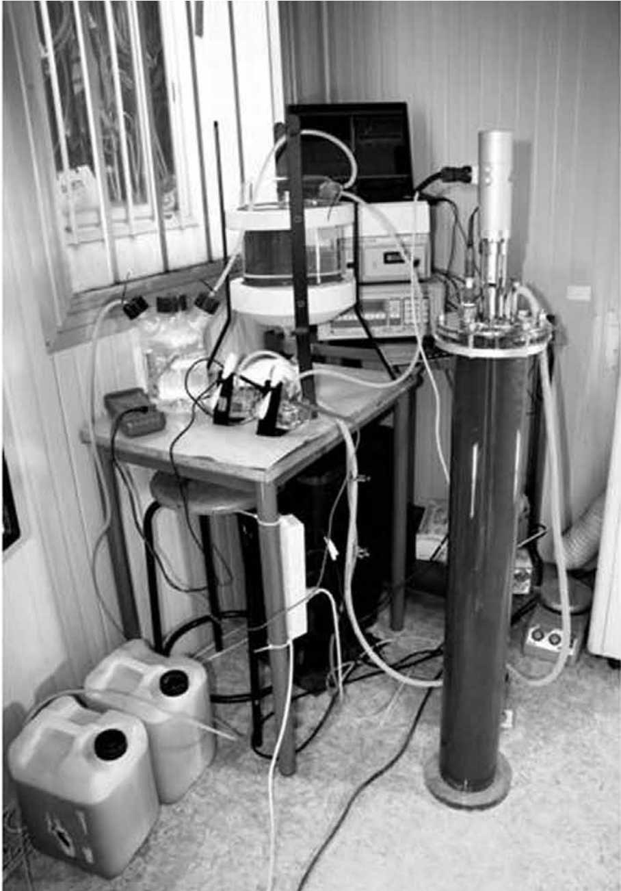
Fig. 5 Fotobioreattore da 11 L operante con Rp palustris 42OL in produzione di idrogeno su fermentato vegetale
