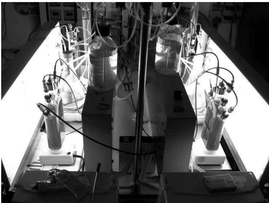
Fig. 4 Apparato utilizzato nello studio di produzione di idrogeno con microalghe. Si possono osservare: fotobioreattore; bottiglia intermedia per la conversione gas ( H_2 ) liquido; bottiglia per l'accumulo del liquido (acqua); sonde il monitoraggio e memorizzazione dei parametri colturali e interfaccia; bilancia elettronica per la misura dell'equivalente idrogeno prodotto
