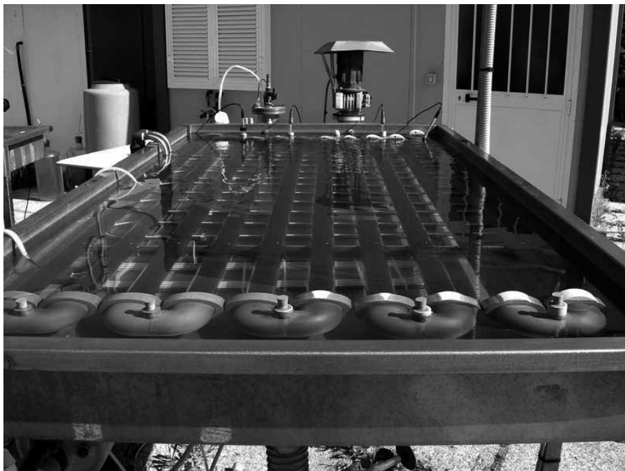
Fig. 10 Fotobioreattore tubolare utilizzato per la crescita e produzione d'idrogeno all'esterno con colture di «Chlamydomonas» reinhardtii
