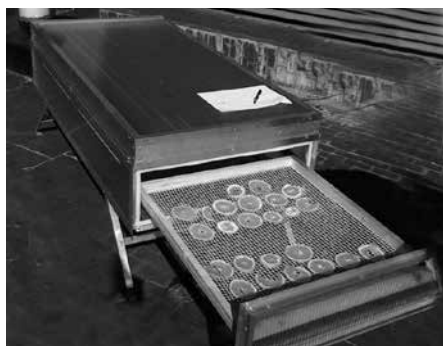
Fig. 6 Essiccatore a energia solare per frutta e ortaggi in pezzi (cubetti, rondelle, dischi, stick)
