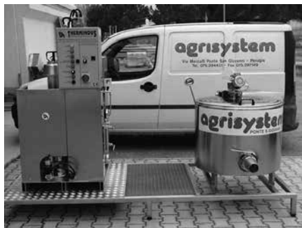
Fig. 5 Minicaseificio alimentato anche con combustibile da biomasse (piccole produzioni casearie)
