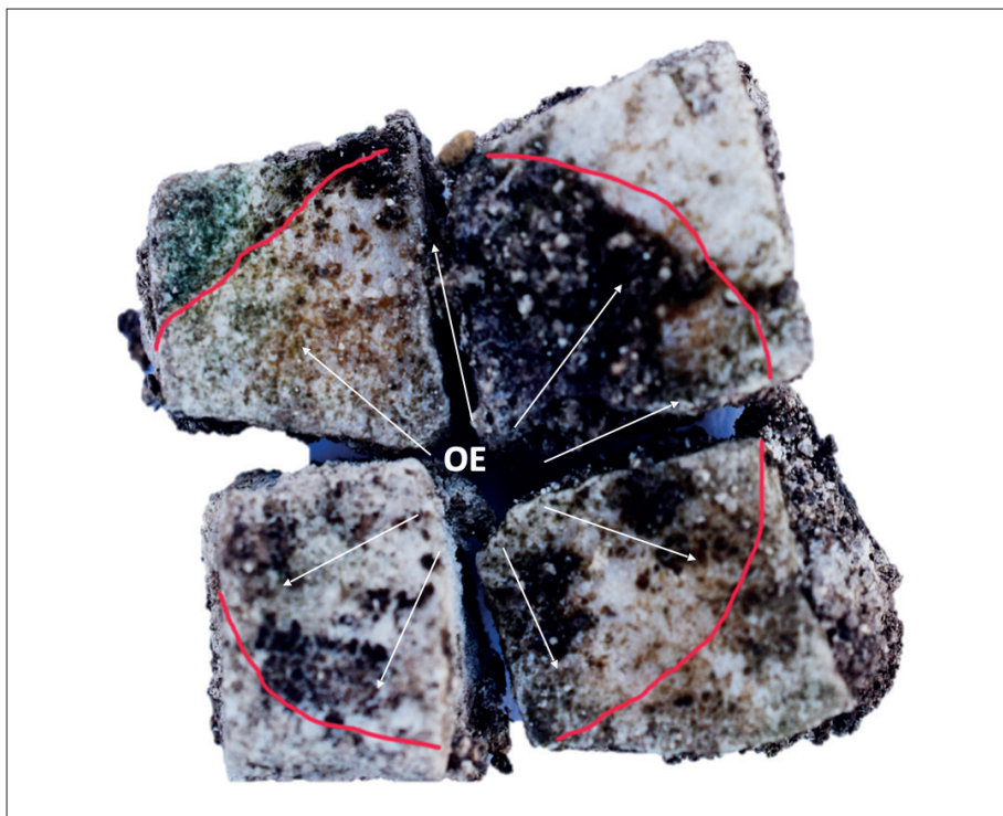
Fig. 1 Tessere del mosaico dopo trattamento con soluzione al 15% di OE di T. vulgaris , che diffondendosi in direzione concentrica rispetto al punto di ingresso (OE) evidenzia una perdita di vitalità del biofilm, tranne nell'area evidenziata in alto a sinistra, in cui il biofilm presenta ancora una colorazione verde
