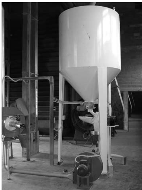
Fig. 2 Particolare del sistema di alimentazione del mais
