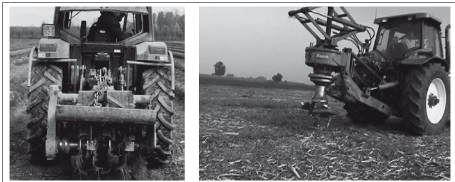
Fig. 5 MO portate dal trattore impiegabili per l'eliminazione delle ceppaie a fine turno: zappa-trice che lavora la fila (a sinistra) (CNER); trivellatrice che disgrega le singole ceppaie (a destra) (Rotor)
