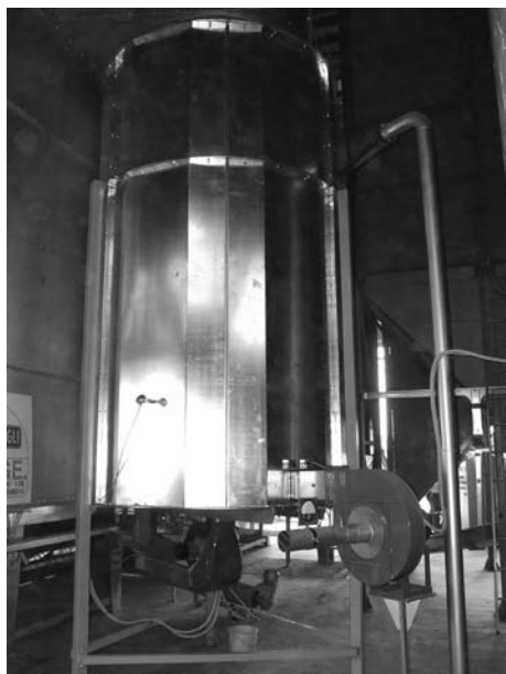
Fig. 1 Combustore polivalente (gasolio e maïs) a fiamma diretta impiegato nella prova
