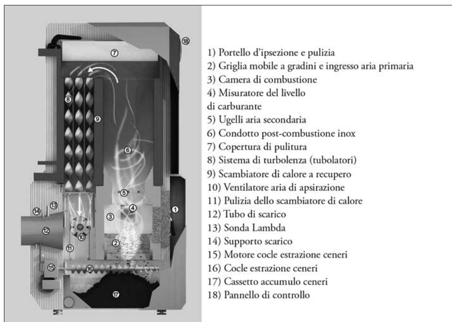
Fig. 18 Sezione di una caldaia a mais
