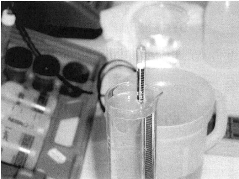
Figura 5 – Densimetro per la misurazione dei cloruri nelle salamoie
