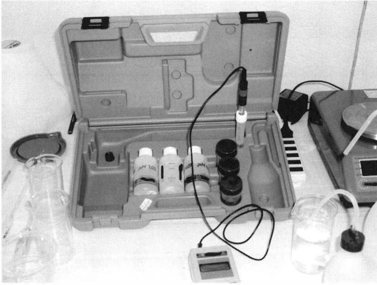
Figura 4 – Valigetta con piaccametro per la misurazione del pH delle salamoie
